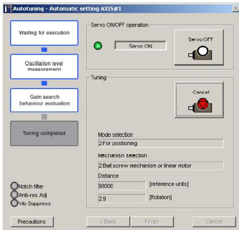
自动检测到调谐中发生的振动，并针对该振动设置进行最合适的参数调整，当设定完成时窗口左边的 LED 灯会亮起。
